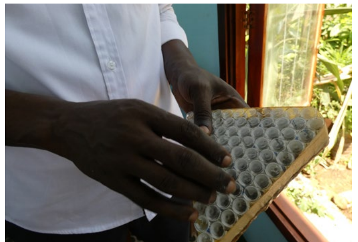
Experimente zur Klimatisierung von Gebäuden mit ausgedienten Medikamentenfläschchen
